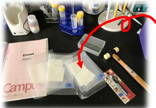
弊社共培養容器は、13mm径の円形フィルターが使用できますが、規格外のフィルターを使用したい場合は、ポンチを使用してサイズを合わせます。市販のポンチ13mm径を購入してください。ポンチは、洗淨・アルコール滅菌して使います。
