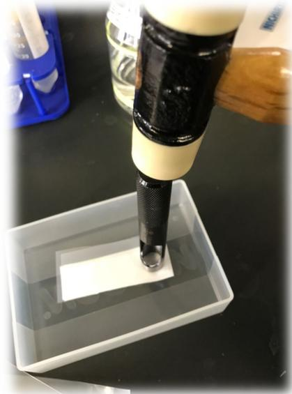
チップ入れの蓋などを利用して、打ち抜き過ぎても実験機が傷付かないように気をつけます。木槌等で叩いて打ち抜きます。最初はコツが必要ですが、慣れれば簡単です。
